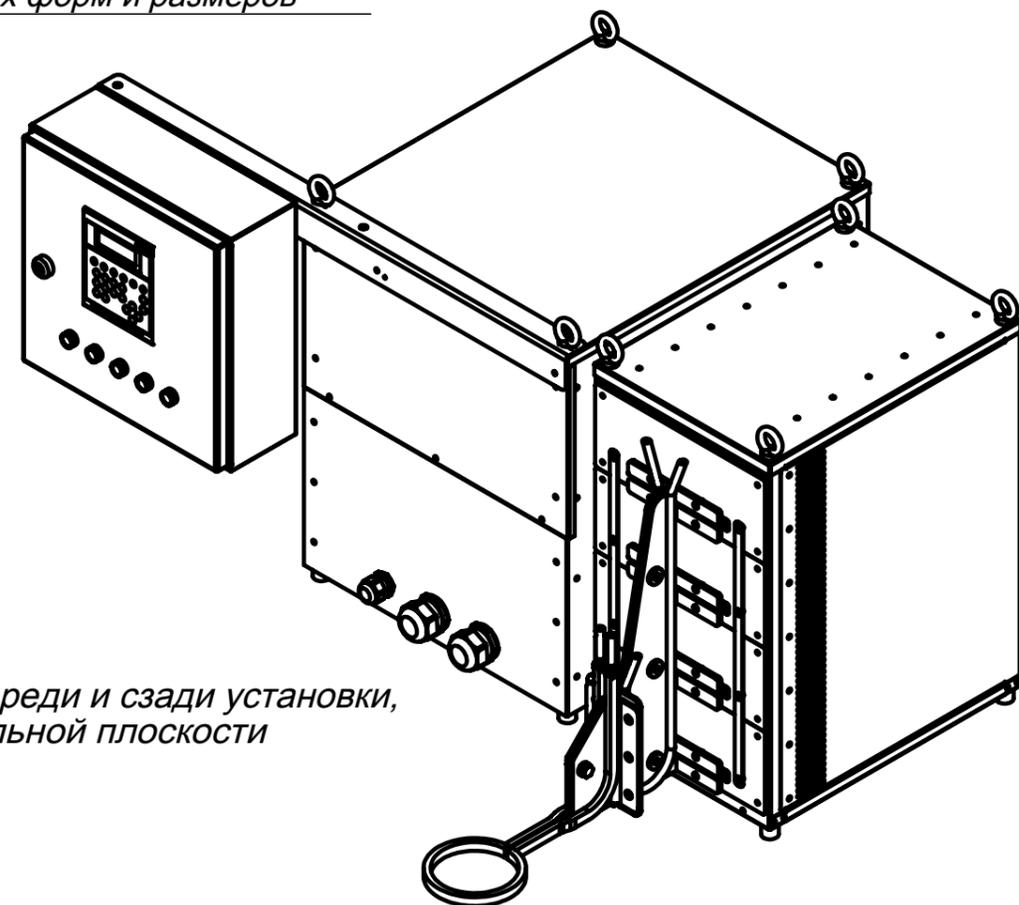
Размещение пульта управления возможно спереди и сзади установки, слева и справа относительно профильной плоскости
