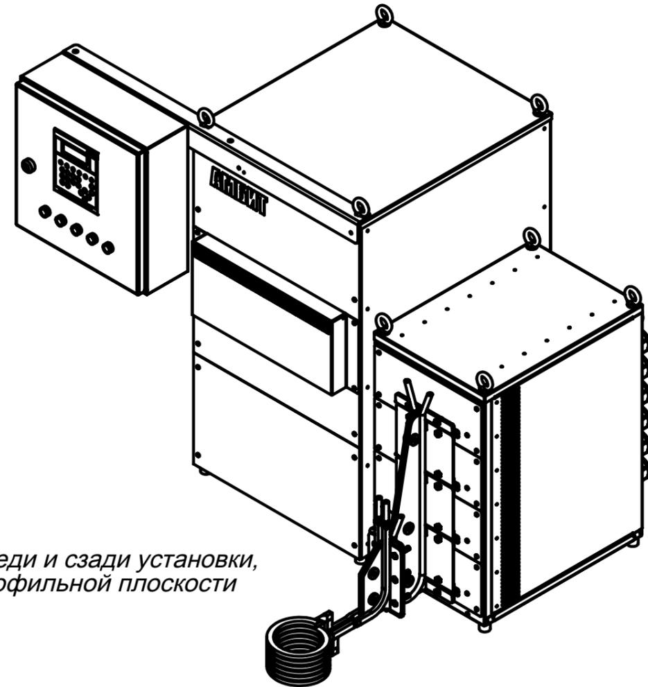
Размещение пульта возможно спереди и сзади установки, слева и справа относительно профильной плоскости
