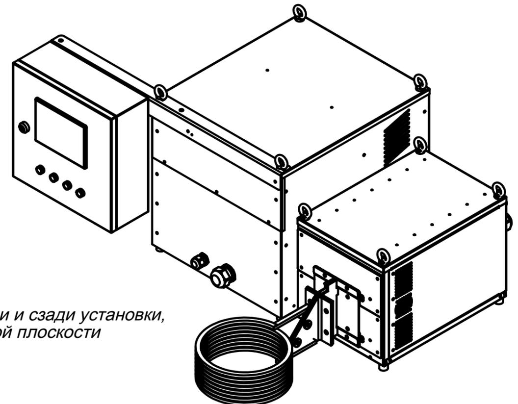
Размещение пульта управления возможно спереди и сзади установки,
